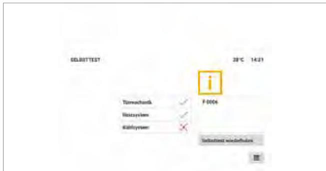
Falls ein Fehler vorliegt, wird der entsprechende Fehlercode angezeigt. Hinter der fehlerhaften Funktion erscheint ein rotes Kreuz. Befolgen Sie die Anweisung am Bildschirm.
