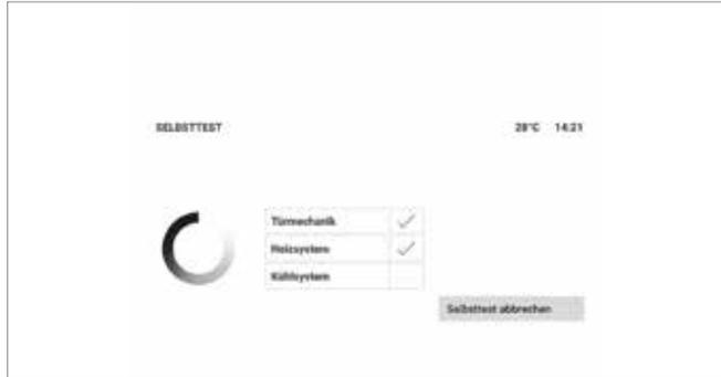
Nach dem Start des Gerätes erfolgt zunächst der Systemtest. Warten Sie diese Phase ab und schalten Sie das Gerät nicht aus.
